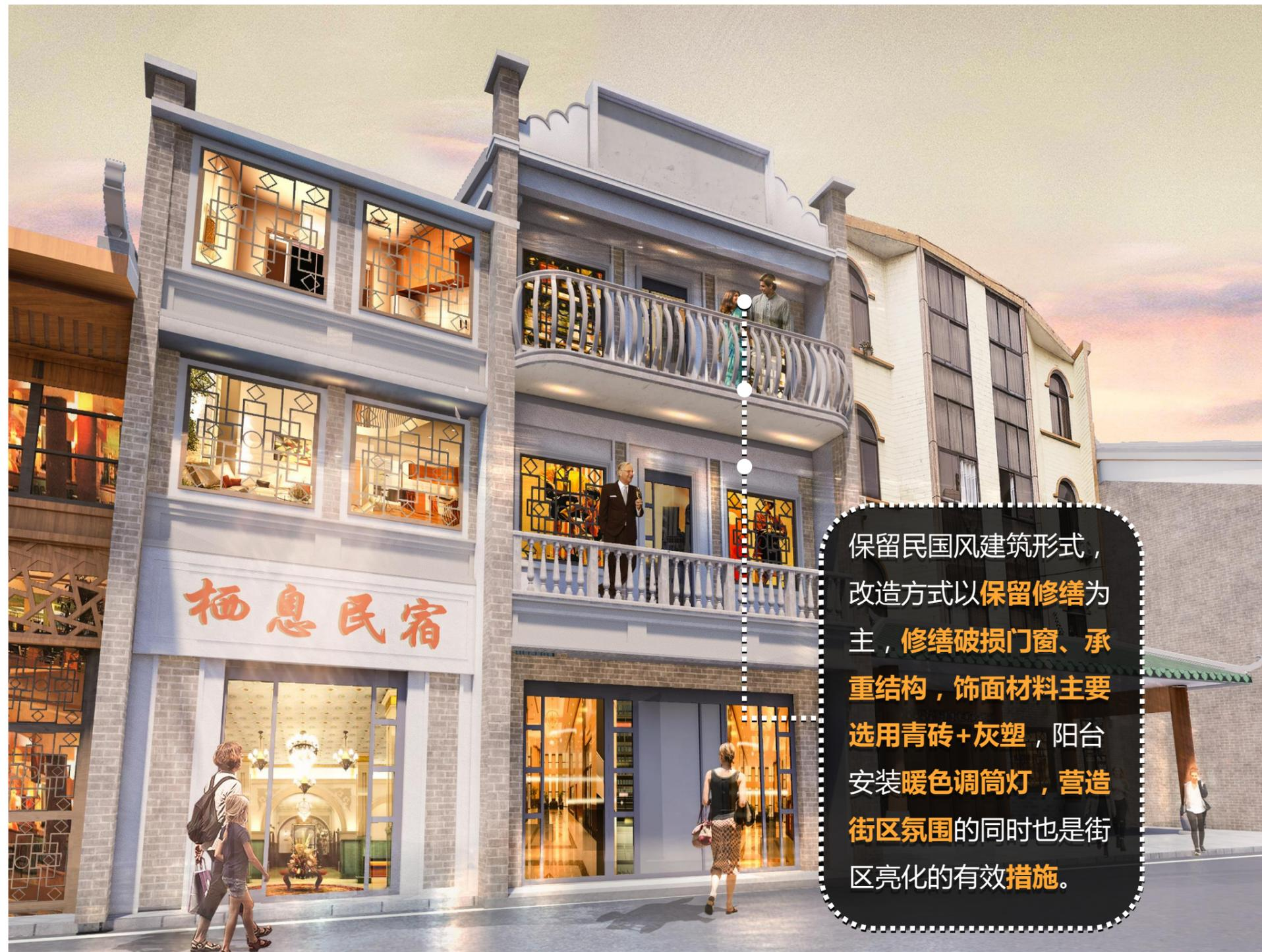
保留民国风建筑形式，改造方式以**保留修缮**为主，**修缮破损门窗、承重结构**，饰面材料主要**选用青砖+灰塑**，阳台安装**暖色调筒灯**，营造**街区氛围**的同时也是**街区亮化**的有效**措施**。
