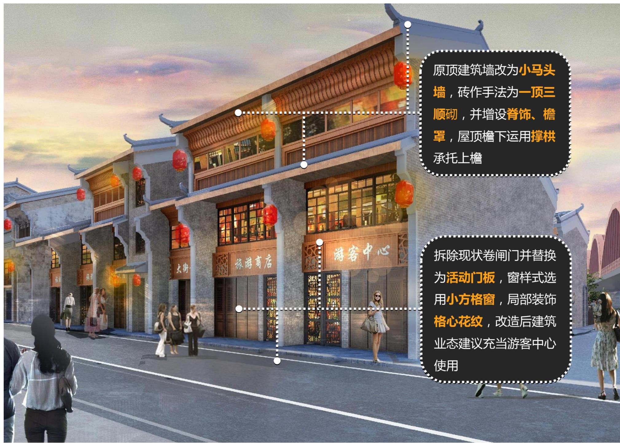
原顶建筑墙改为**小马头墙**，砖作手法为**一顶三顺砌**，并增设**脊饰、檐罩**，屋顶檐下运用**撑拱**承托上檐
