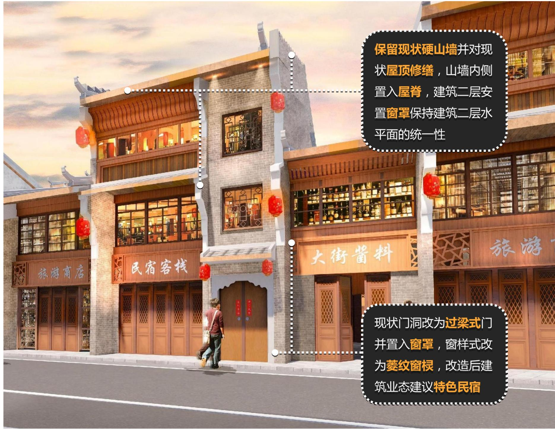
保留现状硬山墙并对现状屋顶修缮，山墙内侧置入屋脊，建筑二层安置窗罩保持建筑二层水平面的统一性
