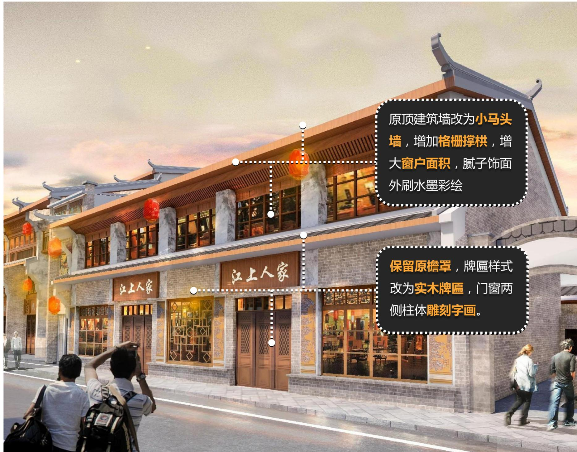
原顶建筑墙改为**小马头**墙，增加**格栅撑拱**，增大**窗户面积**，腻子饰面外刷**水墨彩绘**
